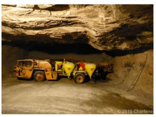
Effizienz der Sprengung. Pro Sprengung fallen Tonnen von losem Material an. Die größten Lader können bis zu 20 Tonnen mit jeder Schaufel transportieren. Die Brocken sind noch sehr grob und werden dann in einer Zerkleinerungsanlage unter Tage zerkleinert, bevor sie über endlose Förderbänder an die Erdoberfläche transportiert werden. Diese Förderbänder sind im Besucherbergwerk allerdings nicht mehr vorhanden. Die Industrieanlagen über der Erde wurden 1993 abgerissen, weil sie marode waren.
