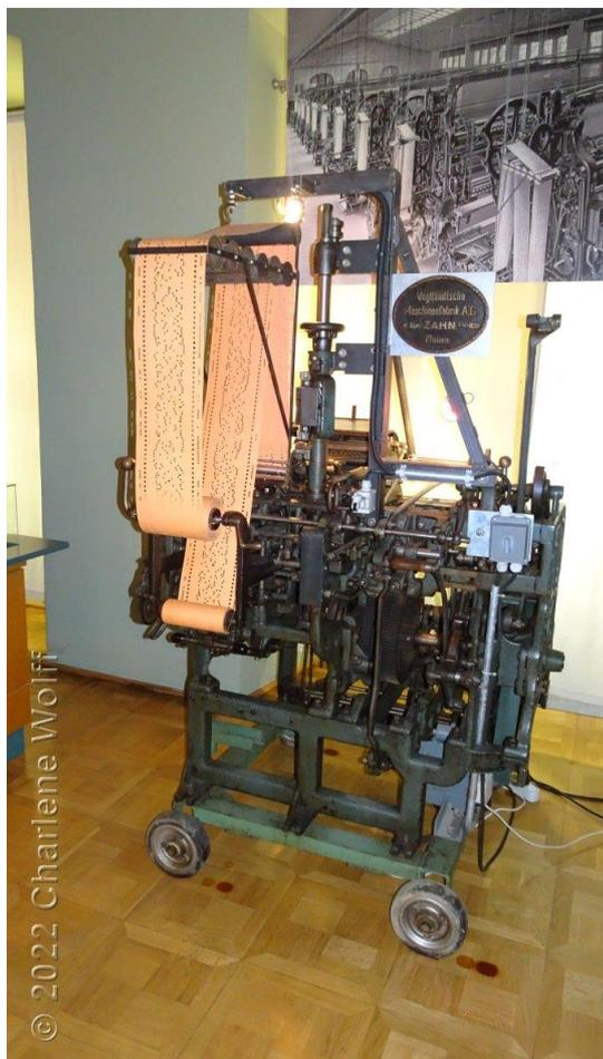
Später gab es Lochstreifenmaschinen, mit der viele Maschinen gesteuert werden konnten. Diese Technik wurde später auch bei den ersten Computern eingesetzt.
